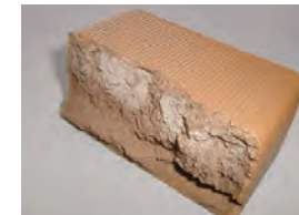
TWシリーズの破断面
